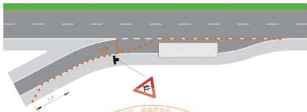
图 20 加速车道上作业区过渡区布置示例
